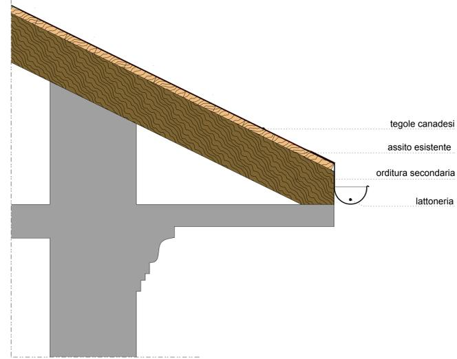
DETTAGLIO COSTRUTTIVO - PROGETTO
